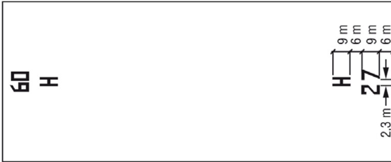
Bild 16. Utformning och proportioner på siffror och bokstäver på bankliknande FATO.
